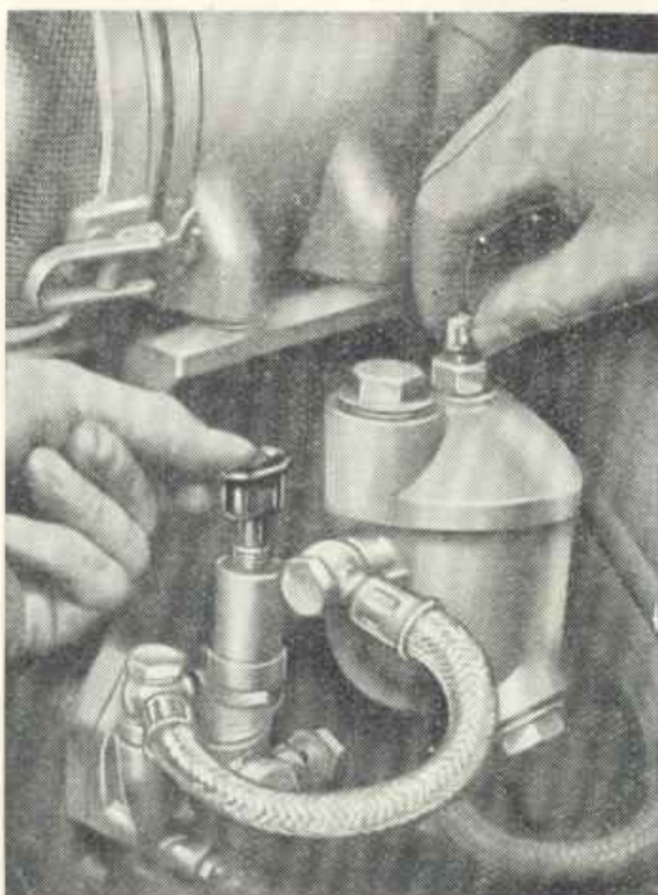
Obraz 146. Odvzdušnit čistič paliva
