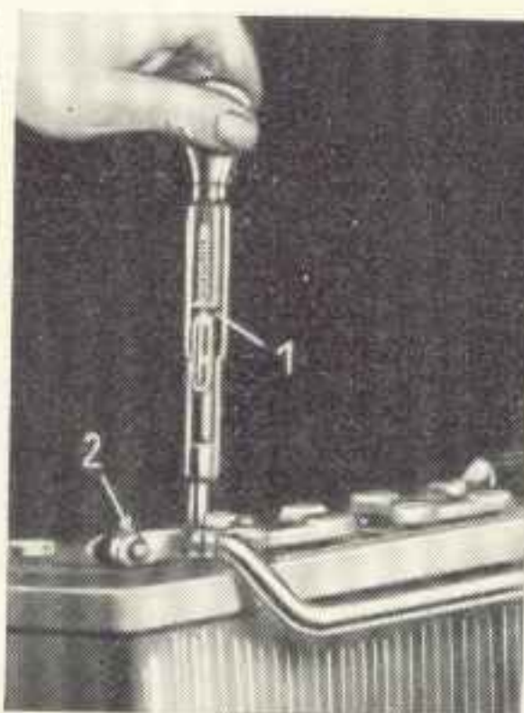
Obraz 209. Zkontrolujte hustotu elektrolytu
