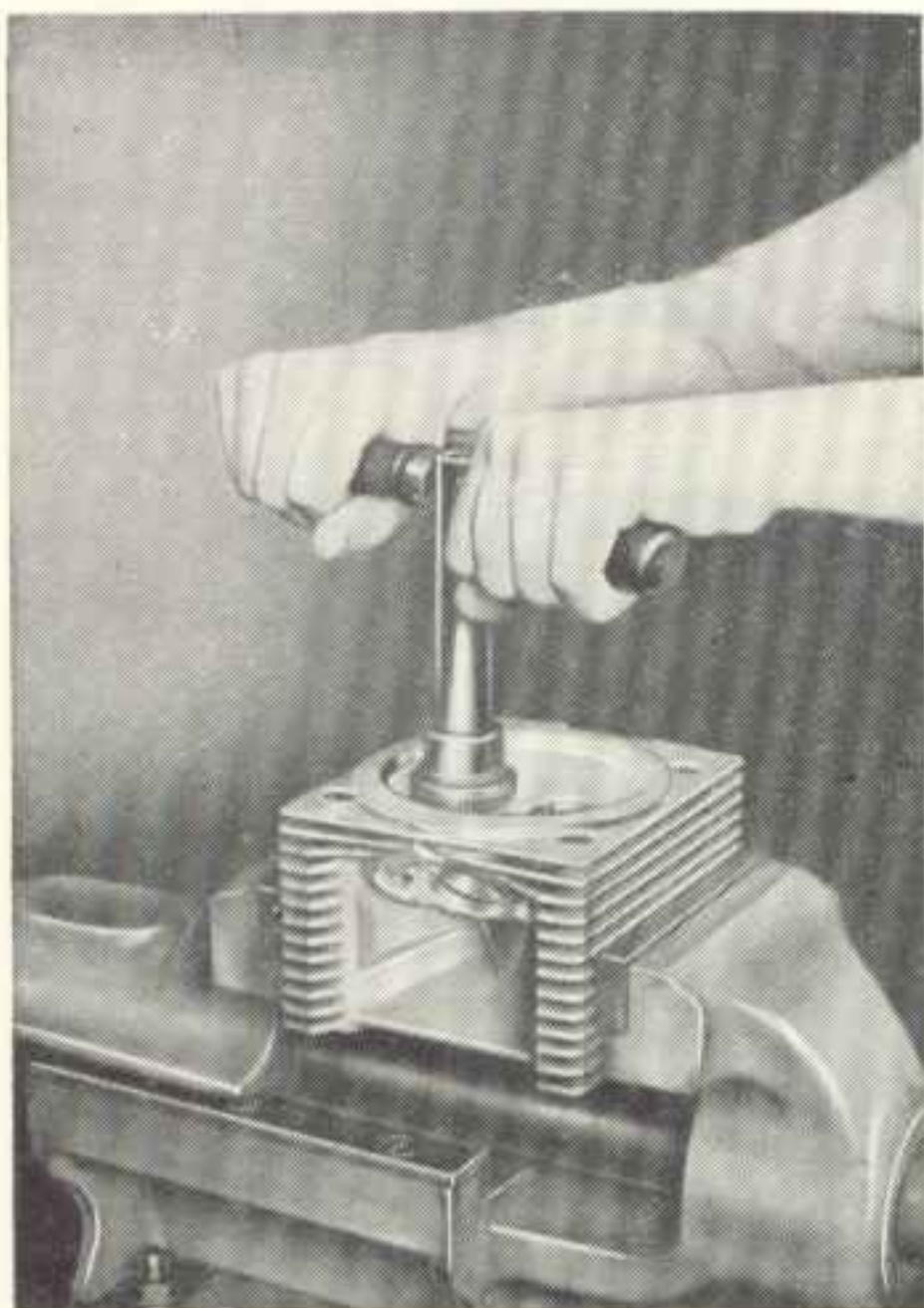
Obraz 109. Sedla ventilů 45° výstružníkem rukou přefrézovat
