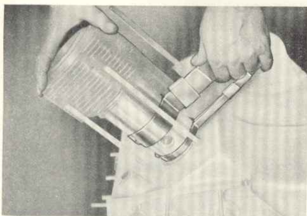
Obraz 94. Válec uložit pomocí montážních svorek, nářadí čís. 323.006-M 38 a 323.006-M 7
