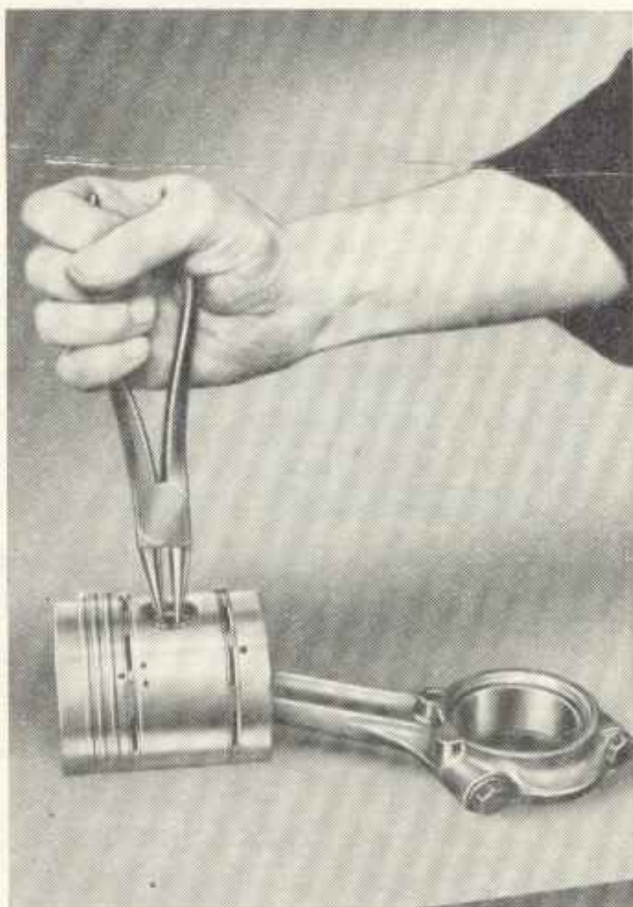
Obraz 81. Pojistný kruh vložit správně do drážky
