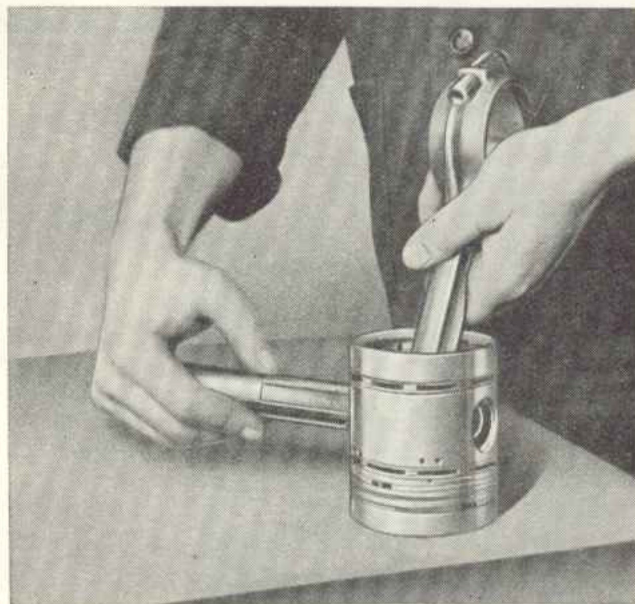
Obráz 80. Pístní čep zasunout vhodným trnem, nářadí čís. 323.006-M 11
