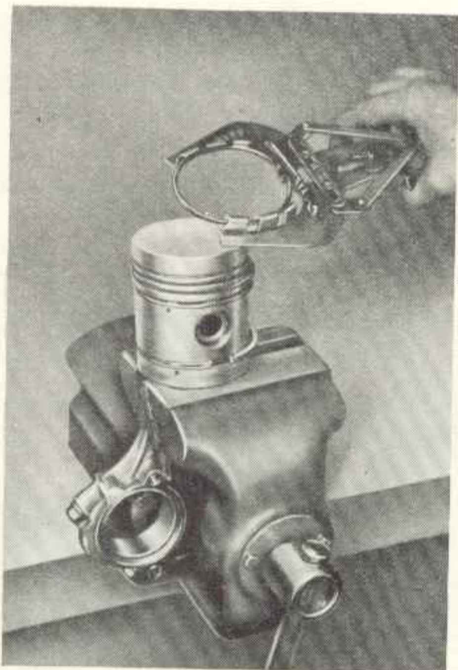
Obraz 89. Pistní kroužky natáhnout kleštěmi na píst
