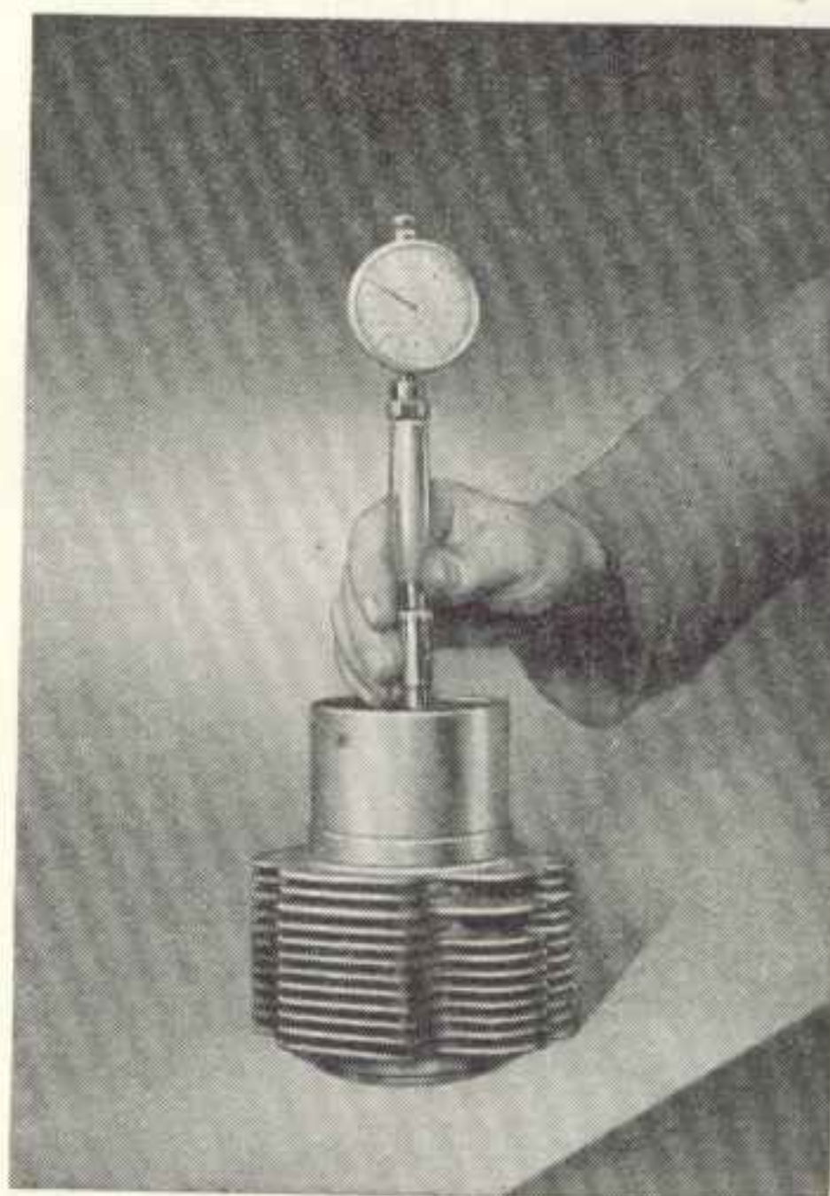
Obraz 92. Válce zkontrolovat pomocí číselníkového úchylkoměru
