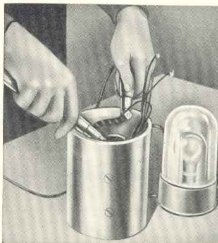
Obraz 186. Zkouška zkratem se žárovkou
