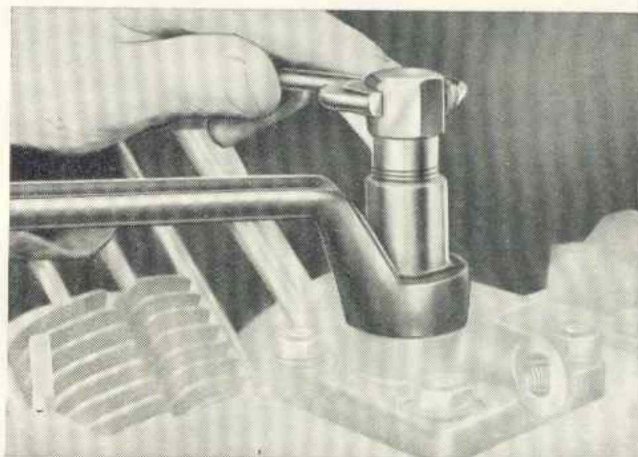
Obráz 153. Stahovákem, nářadí čís. 323.006-M 23 vytáhnout tlačný ventil vstřikovacího čerpadla
