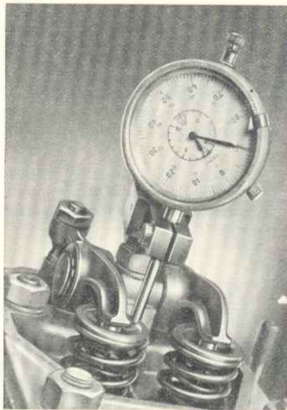
Obraz 122. Přezkoušení rozvodových časů pomocí držáku číselníkového úchytkoměru, nářadí čís. 323.006-M 37
