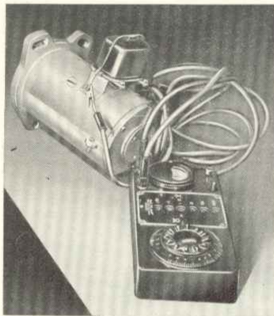
Obraz 199. Přezkoušení budicího vinutí na měřiči odporu
